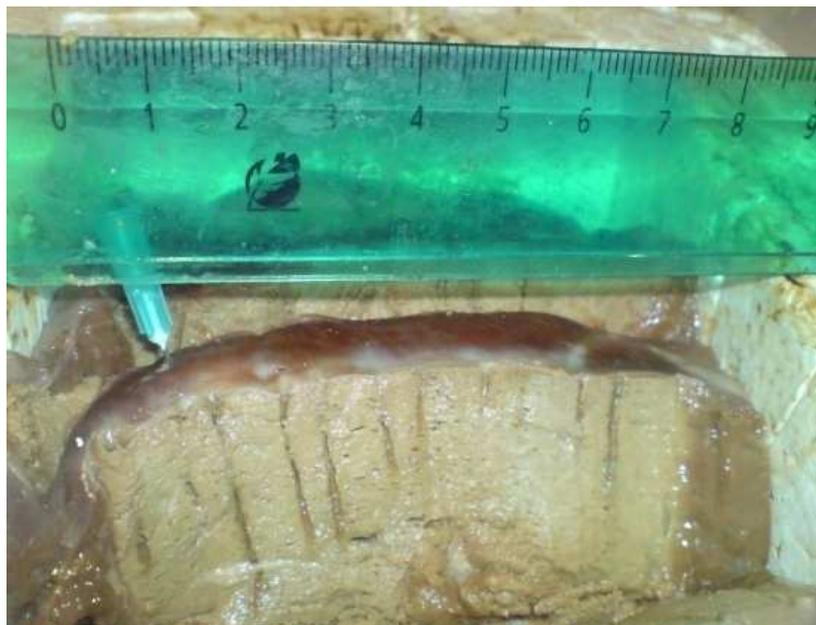
Рисунок П.3.8. Протяженность зоны коагуляции после воздействия линейной системой электродов в течение 5 минут
